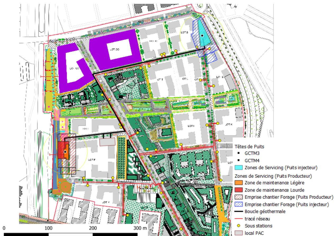
Figure 117: Plan de masse de la ZAC prévu en fin d'aménagement avec situation de puits de géothermie.
