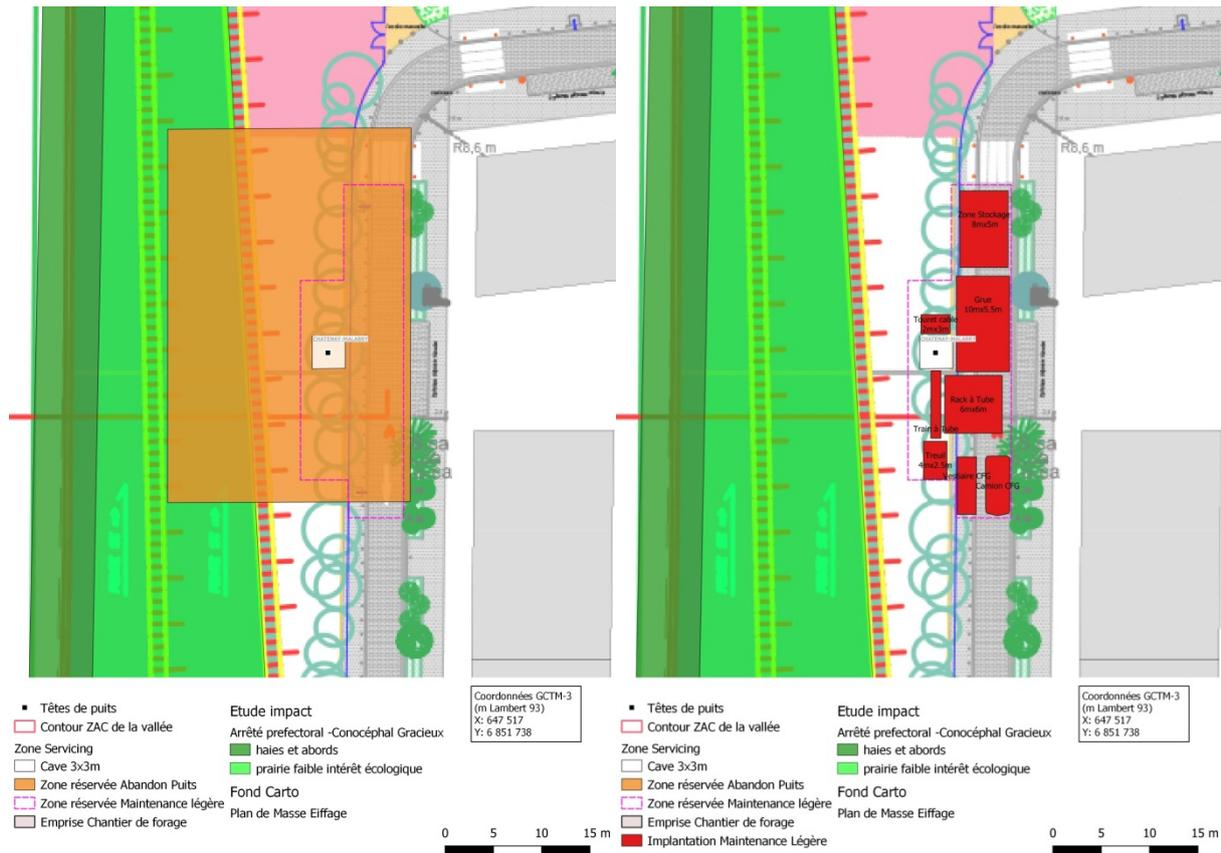
Figure 31 : Emprise de la zone de maintenance légère et exemple de travaux de maintenance légère (Fond autocad) au niveau du puits producteur
