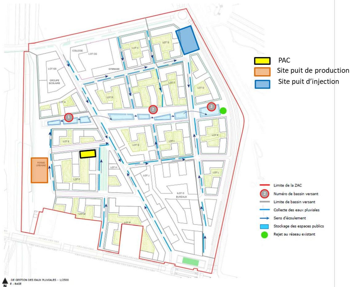
Figure 173: Connection des sites de forages et de la PAC au réseau d'eau pluviale prévu pour la ZAC (Source : Dossier Loi Eau, avril 2018)
